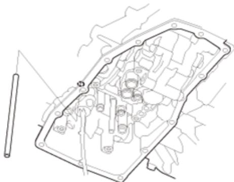
8. 拆下  $12 \times 57.5$  mm 管 (A) 和 O 形圈 (B)。
