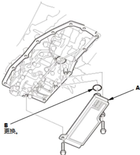
2. 用压缩空气彻底清洁变速器油滤清器的进口 (A)。
