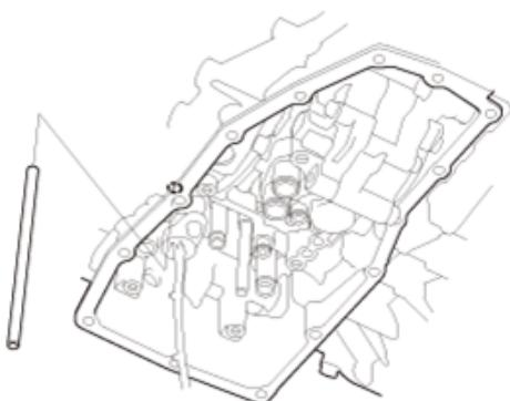
7. 使用新的 O 形圈 (B), 安装  $10.9 \times 25.5 \text{ mm}$  管 (A)。
